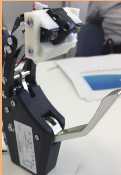
触覚センサ搭載の ロボットハンド
